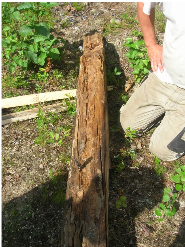
11 07 29.Överst del av en kasserad timmerstock. På nedre fotot ser man gränsen för hur långt myrangreppet har nått. Myrorna angriper lättast rötat virke. Ur den friska delen togs en halv stock, som iskarvades med en snedskarv på kvarnhusets framsida.
