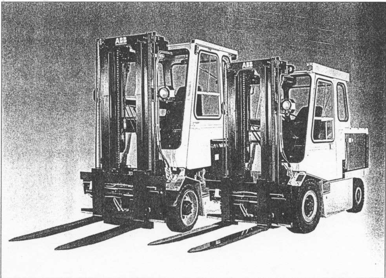
Två truckar av typen AT-300 med frisiktsstativ. Bakom gaffelinfästningen på åkvagnen ans hydraulcylindrarna som reglerar gaffelspridning och sidoförskjutning. Stänkskyddslinjen på AT-serien som nu läggs ned helt, lär enligt obekräftade uppgifter ha formgivits av Sigvard Bernadotte i syfte att göra ASEA-truckarna lättidentifierade. Formlinjen fick emellertid brytas för att lämna utrymme åt säkrare fotsteg. Okänd fotograf. Foto från produktblad för Hernöverken.
