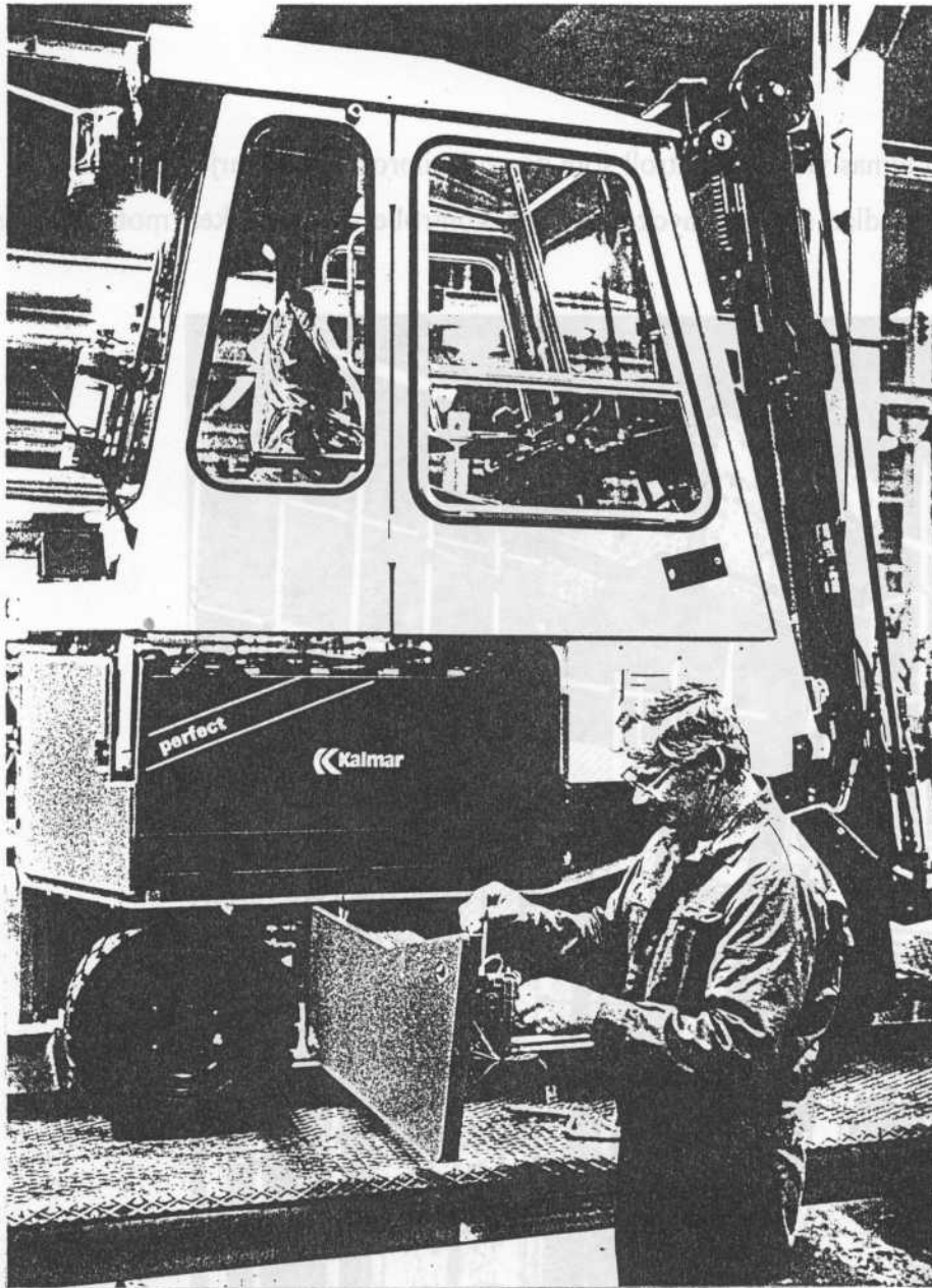
Pentti Jokinen justerar lyfthastigheten på tyristorplattan.
