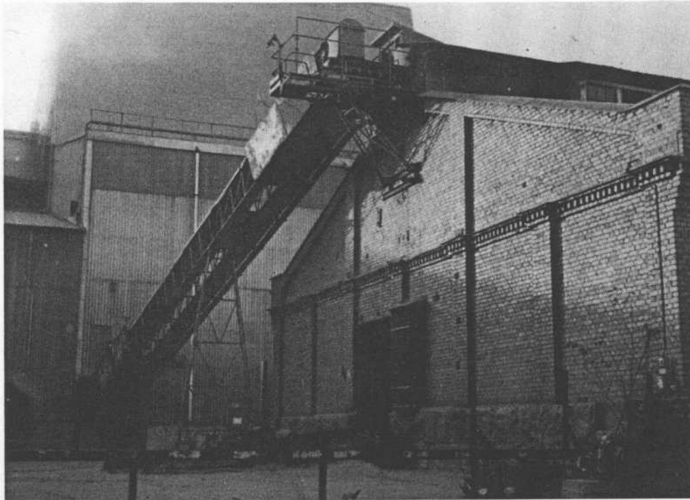
Det kiselpulver som inte skall gå till keramtillverkning går med transportör till förpackningsbyggnaden nr 328.
