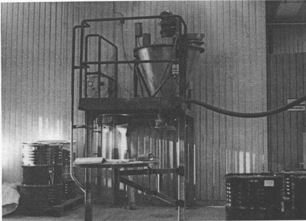
Kulkvarnen som maler kislet till ett ytterst fint pulver.
