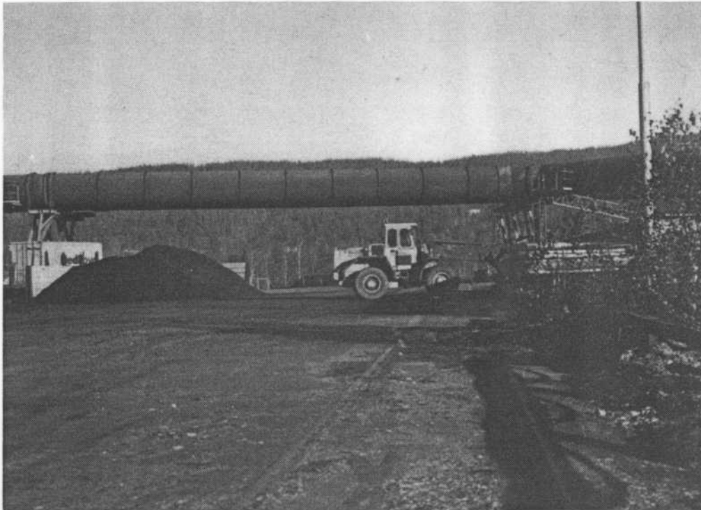
Kvartsupplag. Kvartsen lastas i en transportör för att sedan blandas med kol och flis. I bakgrunden syns filteranläggningen.
